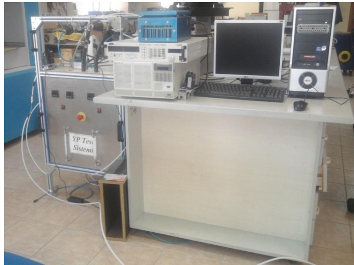
Şekil 6.1. PEM yakıt pili deney düzeneği
