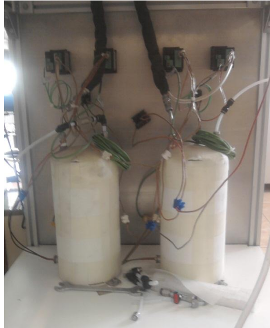
Şekil 6.4. Hidrojen ve oksijen gazlarının nemlendirme düzeneği
