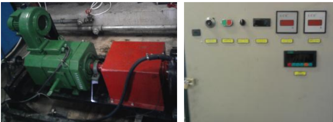
Şekil 3.22. Motor test düzeneğinde kullanılan dinamometre ve kontrol panosu
