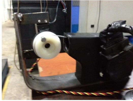
Şekil 3.26. Servo motorun gaz kelebeği bağlantısı
