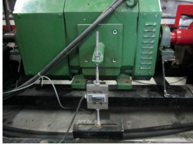
Şekil 3.1. Kullanılan yük hücresi ve motor bağlantısı
