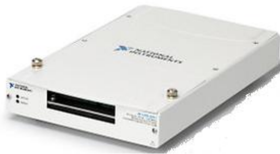
Şekil 2.3. Veri Toplama (DAQ) Kartı (Ni, 2010)
