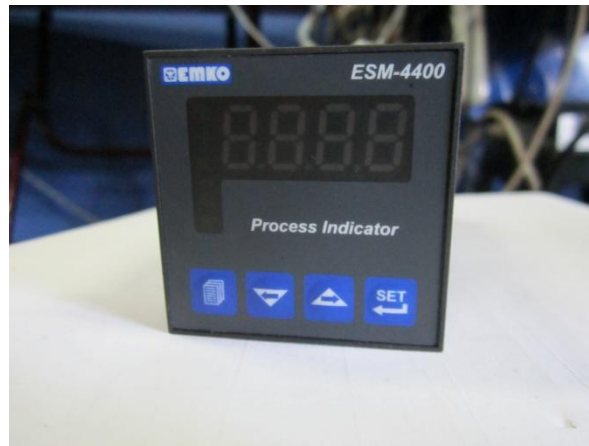
Şekil 3.18. Termokupl için kullanılan kontrol cihazı
