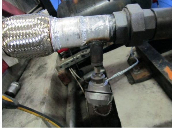
Şekil 3.17. Kullanılan termokuplun egzoz girişine bağlantısı
