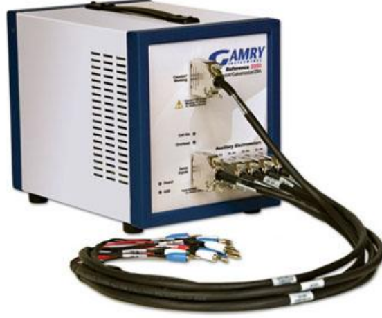
Şekil 4.4 Tez çalışmasında kullanılan Gamry Reference 3000 tipi potensiyostat.
