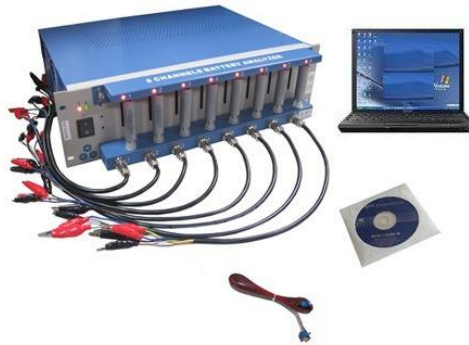
Şekil 4.5 Galvanostatik şarj/deşarj testleri için kullanılan elektrokimyasal analiz cihazı.
