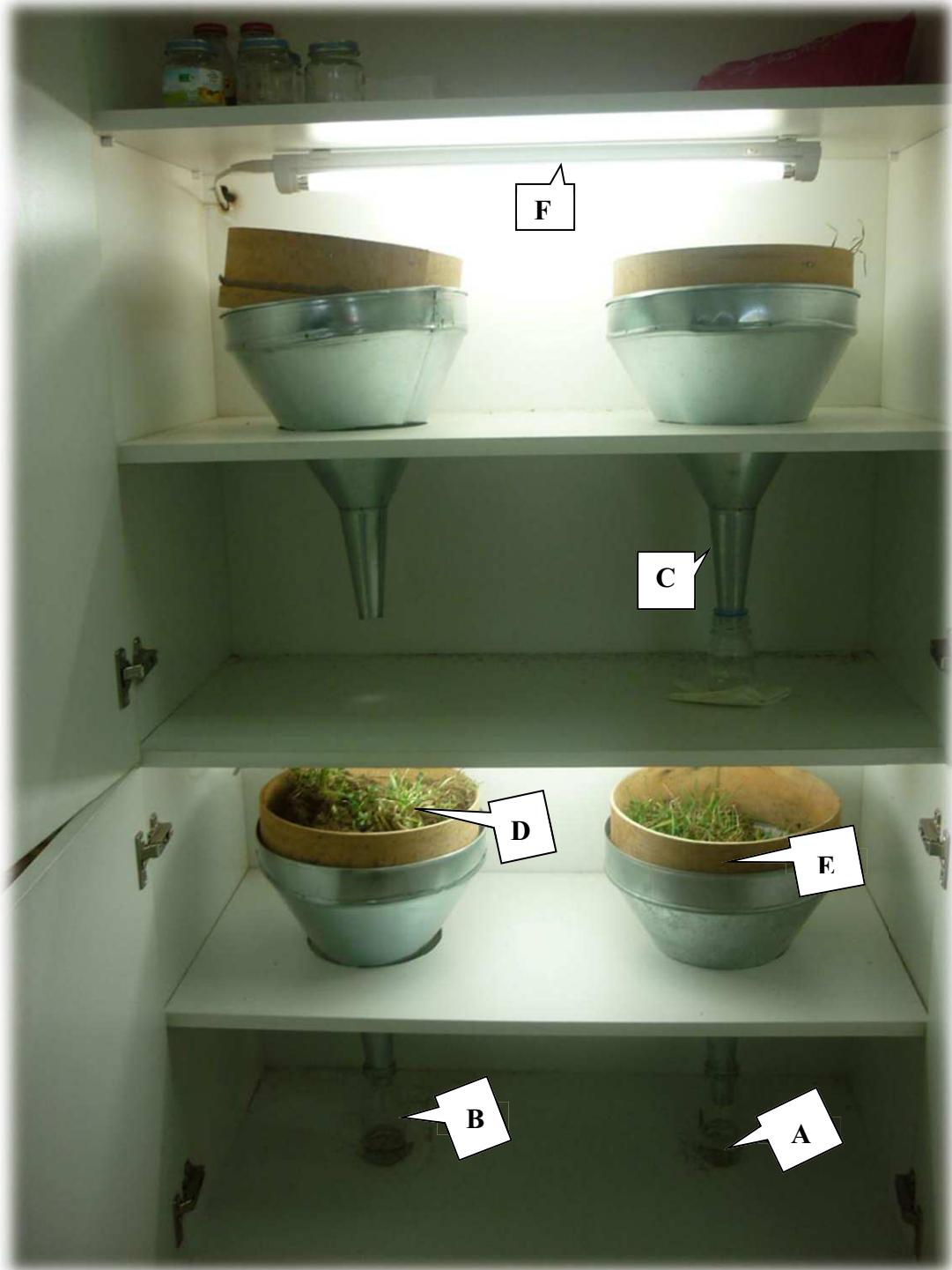
Şekil.2.2. Berlese hunileri A) toplama sıvısı (%70'lik alkol) B) toplama şişesi C) huni D) toprak örneği E) elek F) ışık kaynağı.
