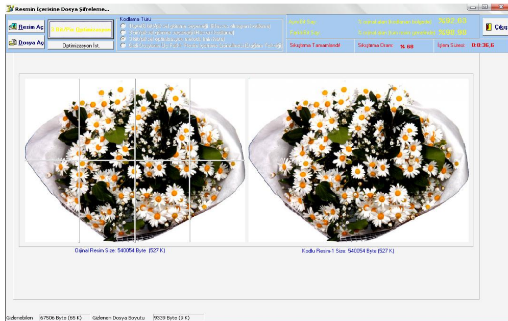
Şekil 5.18. Lzw sıkıştırması tabanlı kısmi optimizasyon yöntemi ile veri gömme uygulaması
