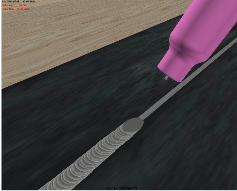
Şekil 4.18. TIG Kaynak Görüntüsü (Ark kopmuş hali) [54]
