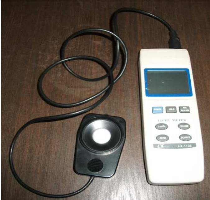
Şekil 5.4. Ölçümlerde kullanılan lutron LX 1108 lüksmetre
