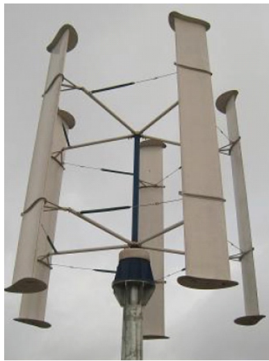
Şekil 3.4. Düşey Eksenli Bir Rüzgar Türbini
