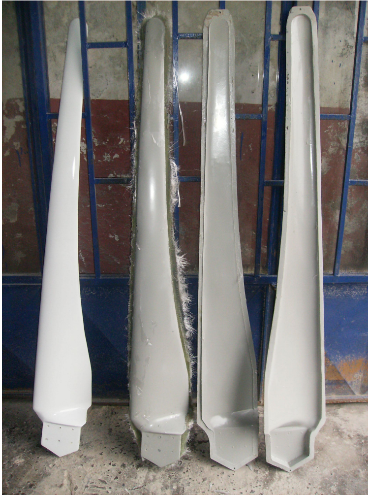
Şekil 5.14. Model, Üretilen Kanat ve Kalıp Yarıları
