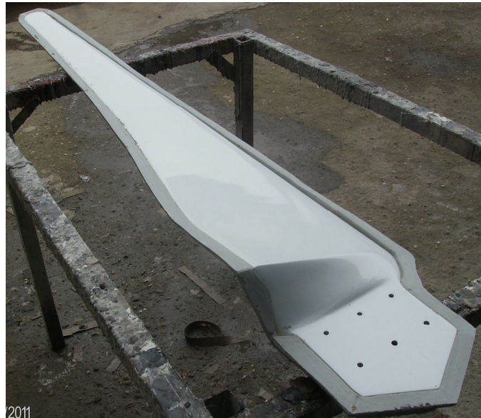
Şekil 5.12. İmal Edilen Poliester Kalıp Yarısı
