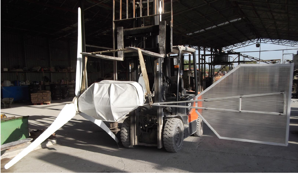
Şekil 5.27. Montaj Edilmiş Türbin Gövdesi
