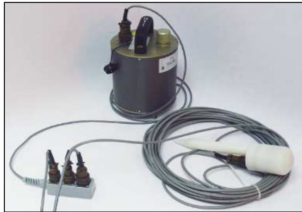
Şekil 8.12. Güralp CMG-6TD sismometresi ve ekipmanları.
