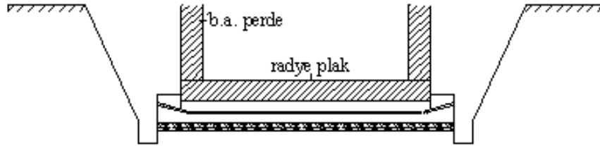
Şekil 5.23. Taşıyıcı konstrüksiyonun yapılması
