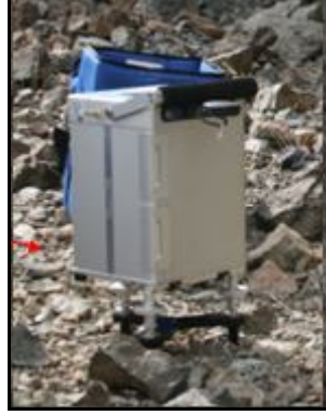
Şekil 3.5. Çalışmada kullanılan CG 5 Autograv gravite ölçüm cihazı
