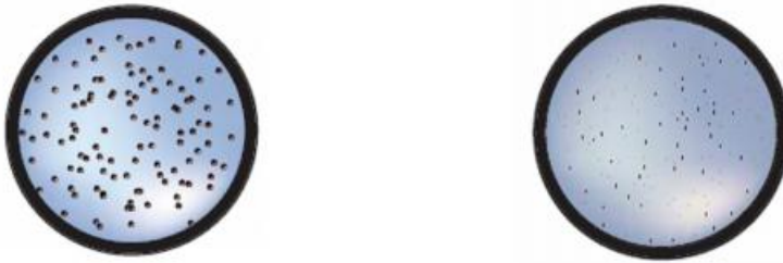
Şekil 3.1. Homojen ve pseudo homojen çamur akışı
