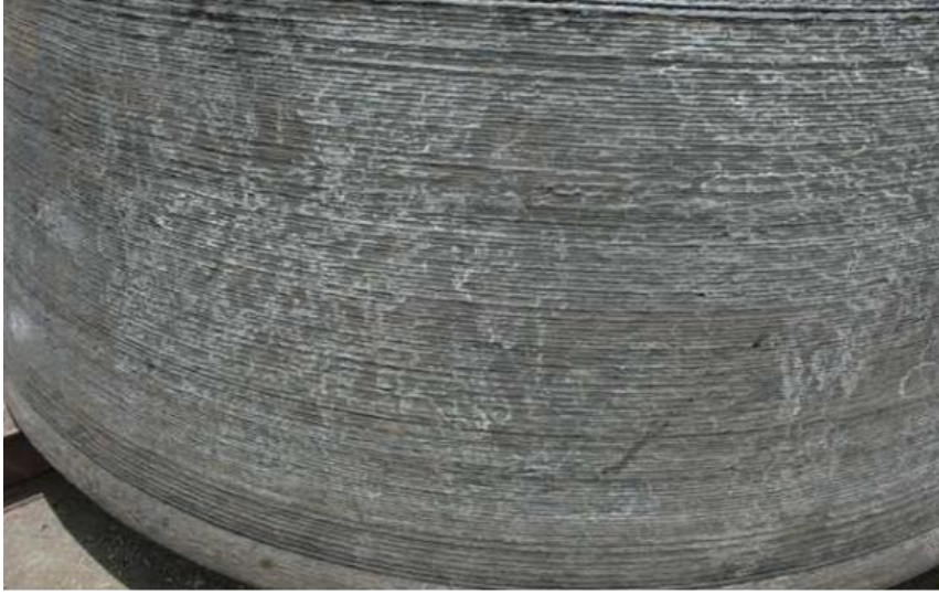
Şekil 4. 38. Valsin dolgu işlemi bittikten sonraki görüntüsü
