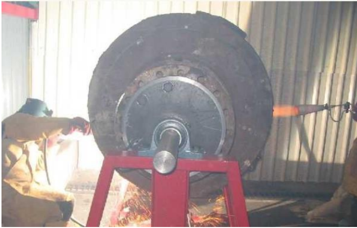
Şekil 4. 33. Kaynak işlemi esnasında valsın sıcaklığı 200 °C sabit tutuluyor
