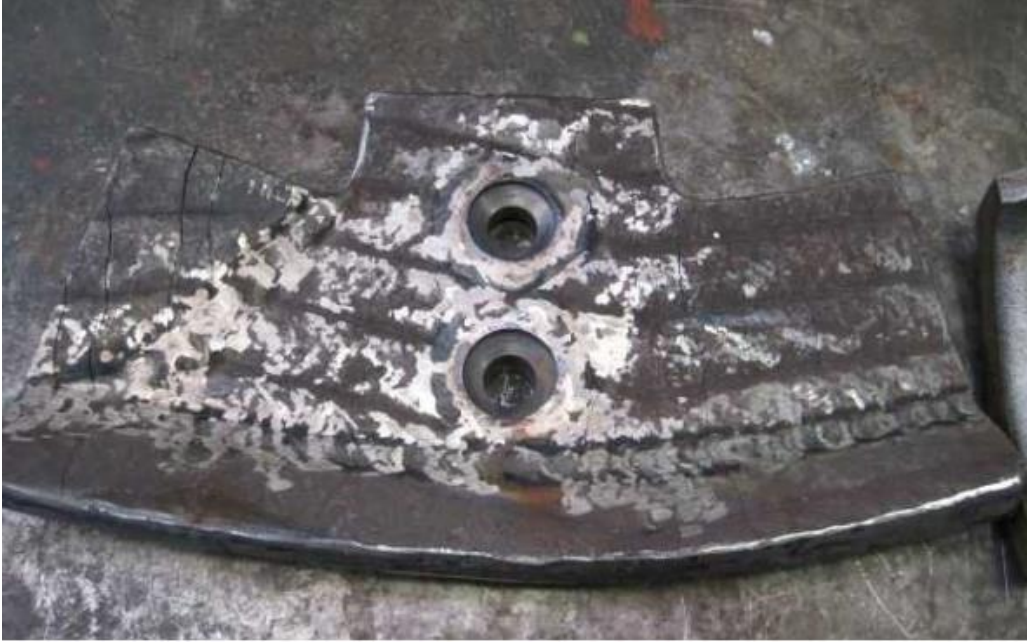
Şekil 4. 16. Castolin 4666 DXW (DIN 8555 MF 10-65-G) den imal edilmiş kazıyıcının yakın görüntüsü
