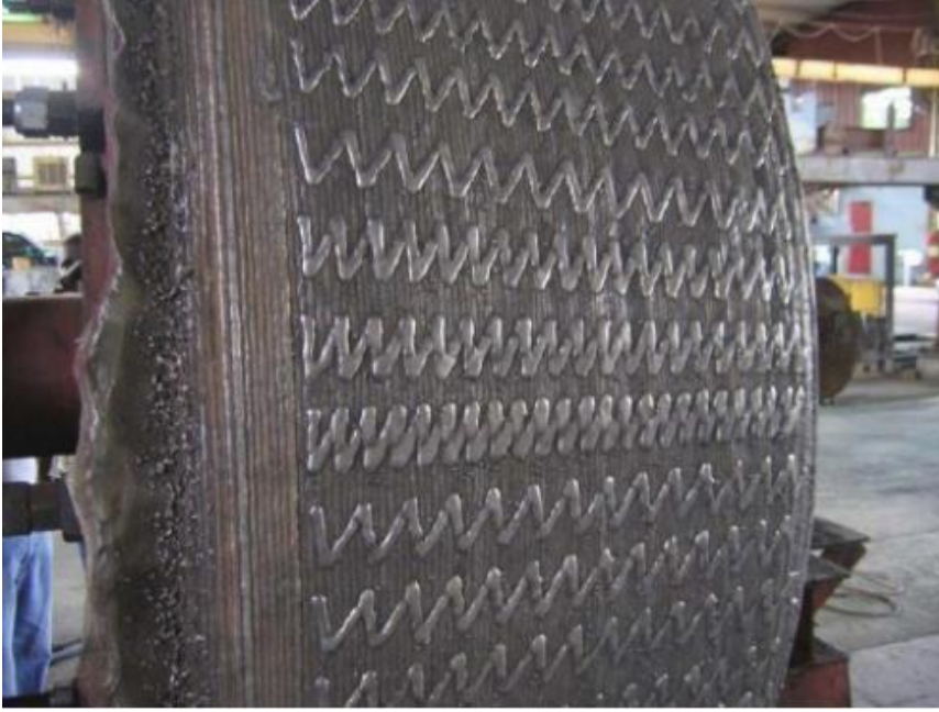
Şekil 4. 30. Valsin Castolin 390N nano teknoloji ürünü ile kaplandıktan sonraki son hali
