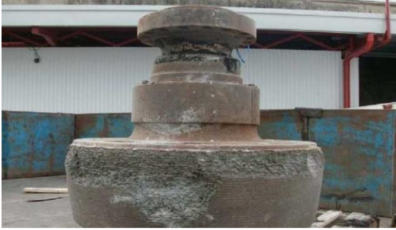
Şekil 4. 32. Valsin Aşınmış Hali
