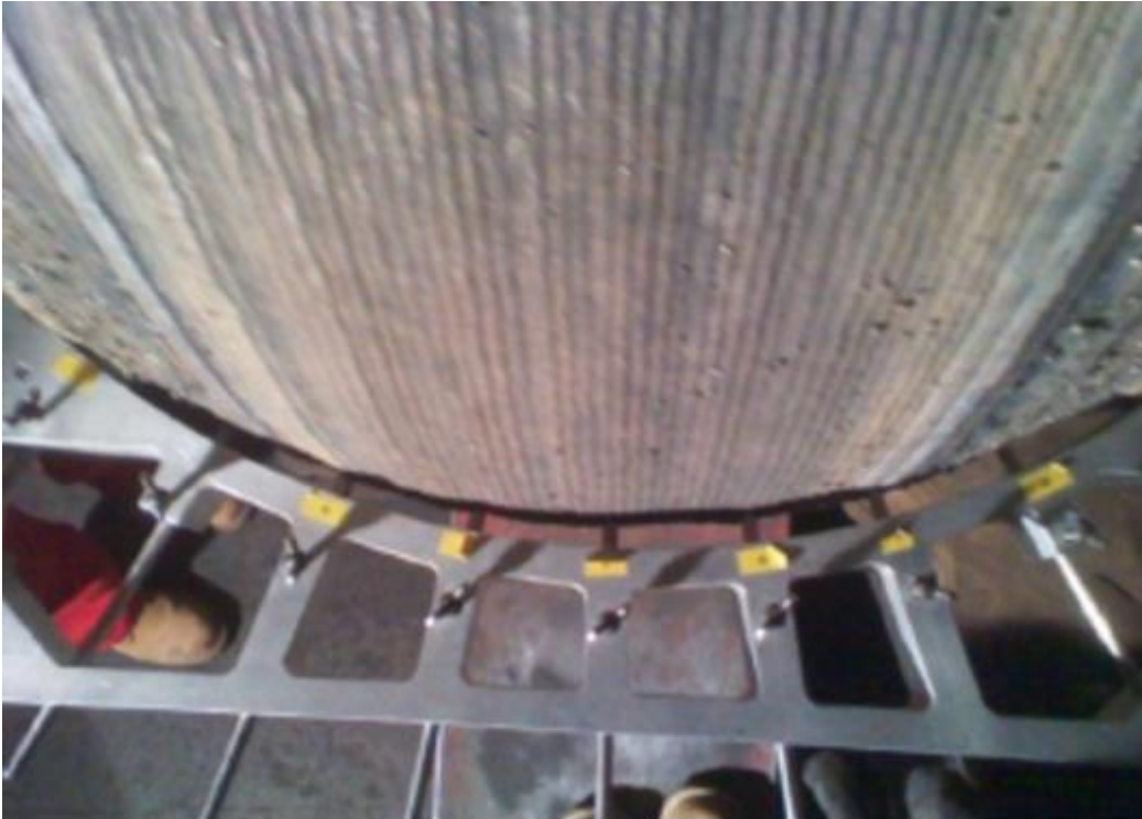
Şekil 4. 25. Castolin 4666 (DIN 8555 MF 10-65-G) özlü teli ile dolgusu yapıldıktan sonra valsın görüntüsü
