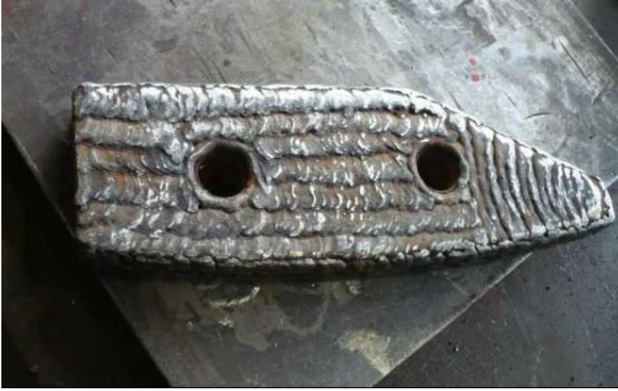
Şekil 4. 21. Kaynak dolgusu bittikten sonra kazıyıcının görüntüsü
