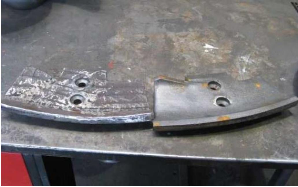
Şekil 4. 15. Castolin 4666 DXW (DIN 8555 MF 10-65-G) ile imal edilmiş kazıyıcı (solda), dökme demir kazıyıcı (sağda)
