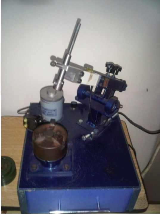
Şekil 5. 1. Ball on disc deney cihazı
