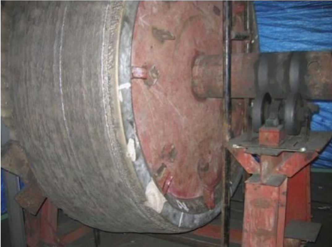
Şekil 4. 29. Valsin Castolin 4601 (AWS A 5.21) ve Castolin 4666 (DIN 8555 MF 10-65-G) ile dolgu yapılmış hali
