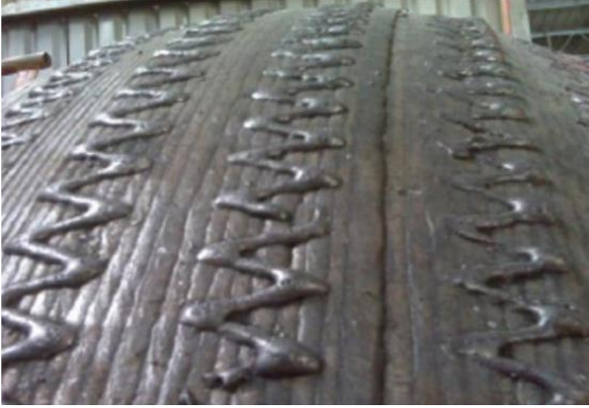
Şekil 4. 26. Castolin 390N nano teknoloji ürün ile pırpır desenli dolgunun görüntüsü
