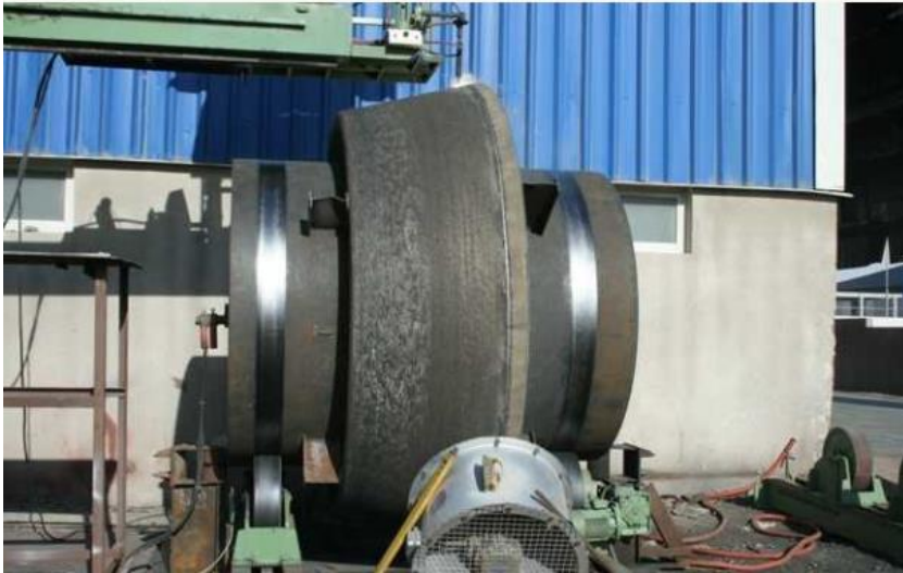
Şekil 4. 35. Kullandığımız pozisyoner ve kontrollü soğutma ekipmanları
