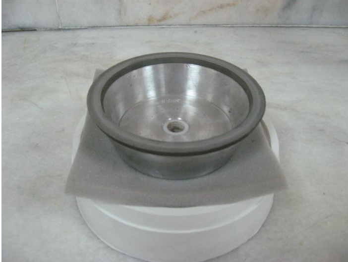
Şekil 5. 26. Seramik kesici takım taşlamak için kullanılan elmas taşlama diski
