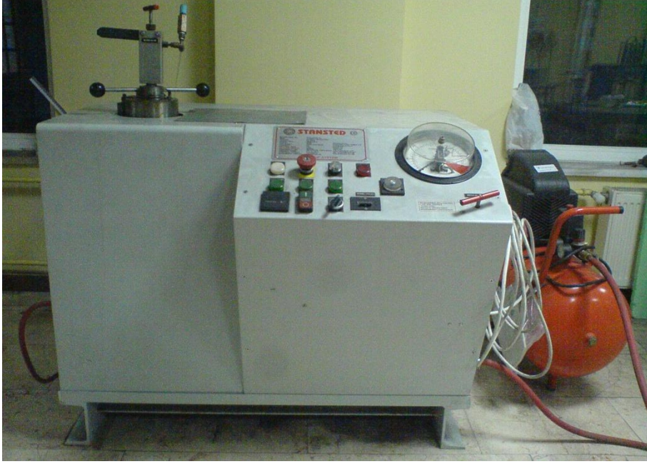
Şekil 5. 15. Seramik peletlerin yoğunluklarının artırılmasında kullanılan soğuk izostatik pres
