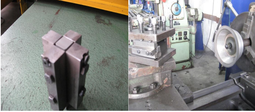
Şekil 5.25. a) Seramik kesici takım bağlama aparatı b) Yüzey taşlama için kullanılan torna tezgâhı
