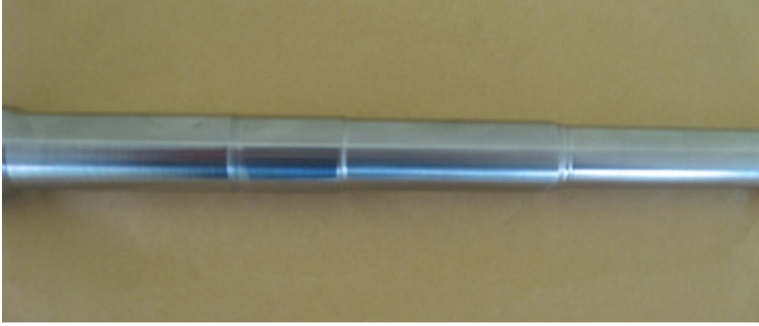
Şekil 6. 39. \beta -SiAlON kesici takımlarıyla sertleştirilmiş AISI 4140 çeliğinin işlenmesi sonucu elde edilen yüzey
