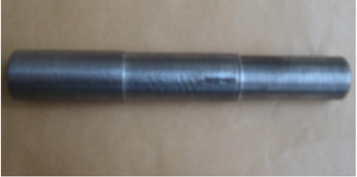
Şekil 6. 38. WC kesici takımlarıyla sertleştirilmiş AISI 4140 çeliğinin işlenmesi sonucu elde edilen yüzey pürüzlülüğü
