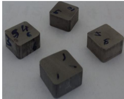
Şekil 5. 23. Kesme performansı testleri için ürettiğimiz eş eksenli seramik kesici takımlar
