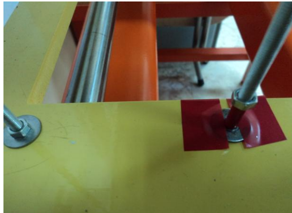
Şekil A.9. ZS7 Hasarlı kolon deneyi için oluşturulmuş hasar durumu
