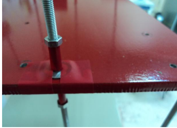
Şekil A.4. ZS6-1S6-2S6-3S6 Hasarlı kolon deneyi için oluşturulmuş hasar durumu
