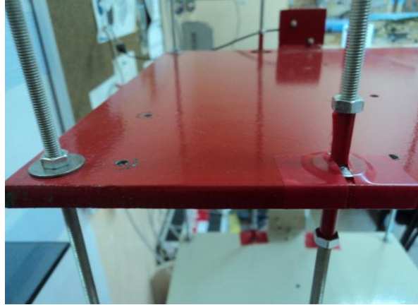
Şekil A.12. ZS7-1S7-2S7-3S7 Hasarlı kolon deneyi için oluşturulmuş hasar durumu
