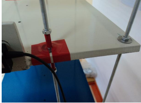
Şekil A.7. ZS3-1S3-2S3 Hasarlı kolon deneyi için oluşturulmuş hasar durumu
