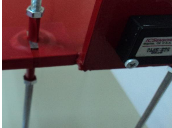
Şekil 4.30. ZS2-1S2-2S2-3S2 Hasarlı kolon deneyi için oluşturulmuş hasar durumu
