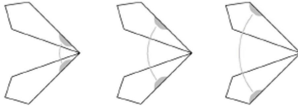
Şekil 3.6. Yüzey akımları elektromanyetik alan meydana getirir. Değişik potansiyellerdeki besleme kolları arasında küresel olarak simetrik TEM dalgası ortaya çıkar ve reflektöre doğru yayılır (Rosenlind, 2009)
