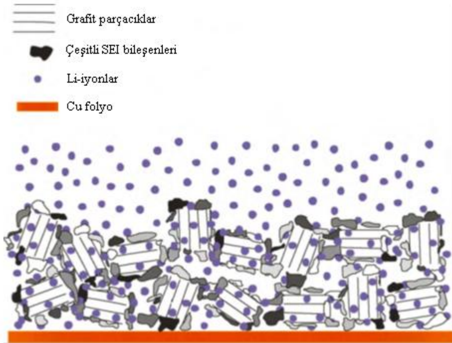
Şekil 3.6. Lityumlanmış grafit elektrot yüzeyinde oluşan SEI tabakası [53]
