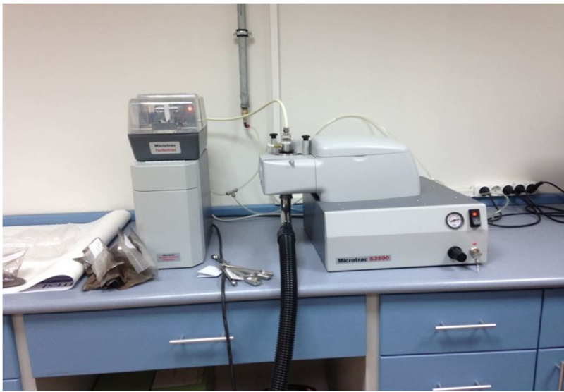
Şekil 5.1. Deneysel çalışmalarda kullanılan partikül boyut analiz test cihazı.
