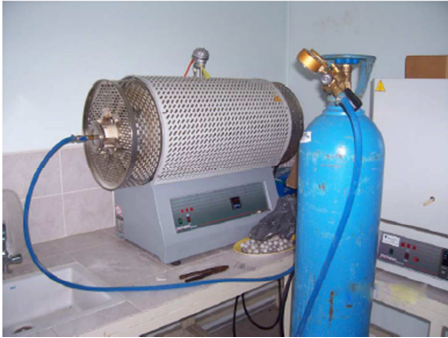
Şekil 5.3. Karbotermal redüksiyon işlemlerinde kullanılan yatay tüp fırın.
