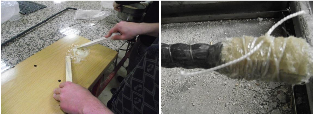
Şekil 4.3. Baş kısımları ezilmeye karşı güçlendirilmiş CTP donatılar
