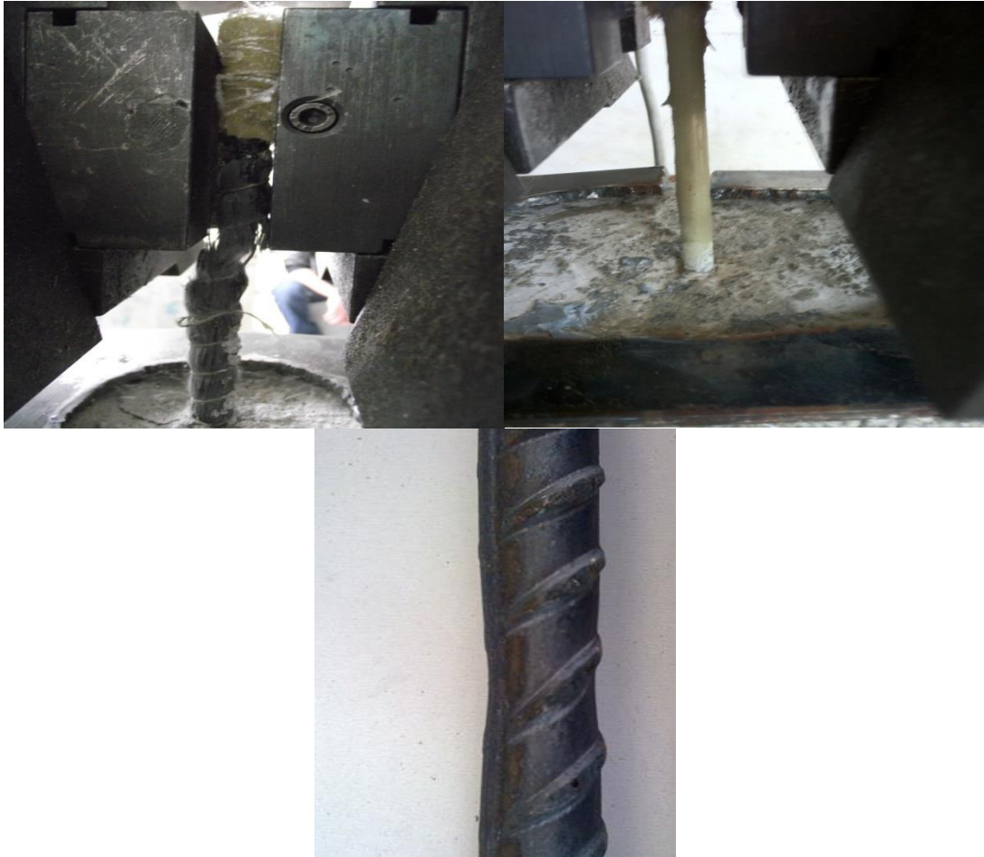
Şekil 5.7. Farklı yüzey özellikli donatıların sıyırılma deformasyonları
