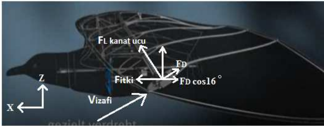
Şekil 4.14. Kanat ucu itki kuvvetinin oluşumu
