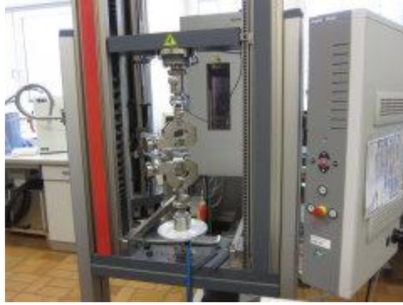
Şekil 4.5. Deneylerde kullanılan Zwick marka Z020 model çekme cihazı [115]
