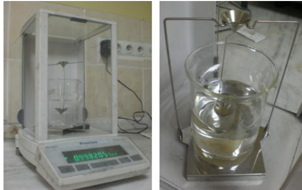
Şekil 4.1. Numunelerin yoğunluklarının ölçüldüğü yoğunluk kitleriyle birlikte 0,1 mg hassasiyetli terazi
