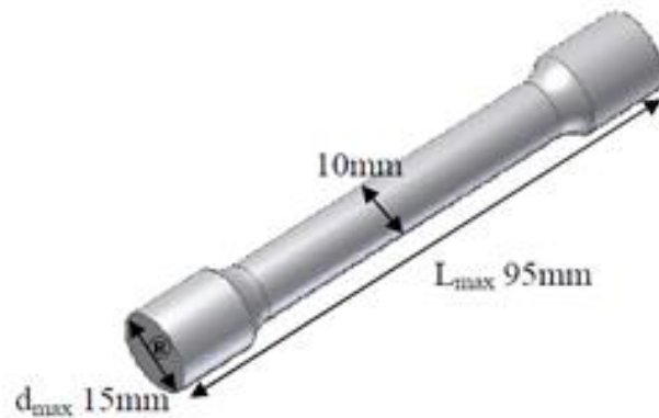
Şekil 4.8. Çekme deneyinde kullanılan numunelerin şekil ve boyutları
