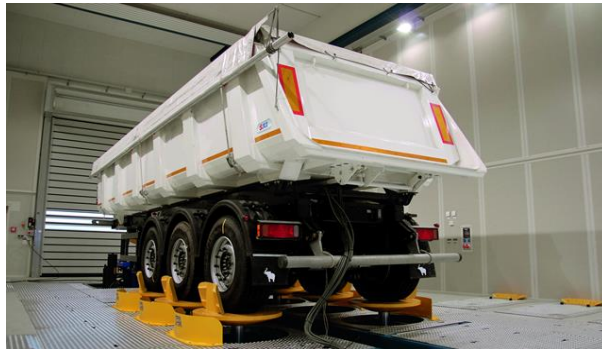
Şekil 2.5. Tekerlek etkileşimli komple araç testi [9].
