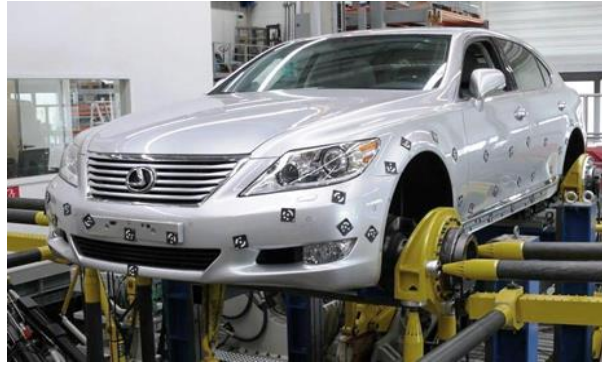
Şekil 2.4. Dingil uyartılı komple araç testi [8].
