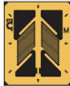
Şekil 3.12. Tork tipi 45 derece gerinim ölçer (strain-gauge) [24].
