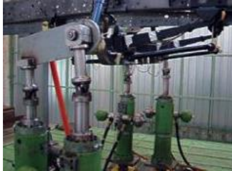
Şekil 2.6. Ticari bir araca ait süspansiyon bileşeninin yorulma test düzeneği [10].
