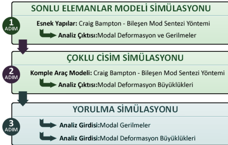
Şekil 4.4. Modal tabanlı sanal prototip yorulma analizi süreci.
