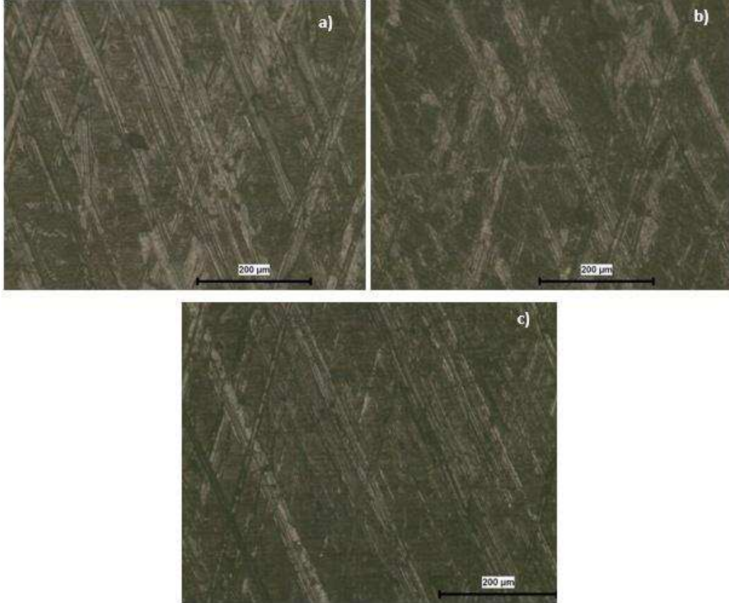
Şekil 5.14. Dökme demir 100 N yük altında a) 60 b) 80 c) 120 dev/dak kayma hızı şartlarına ait aşınma mekanizmaları
