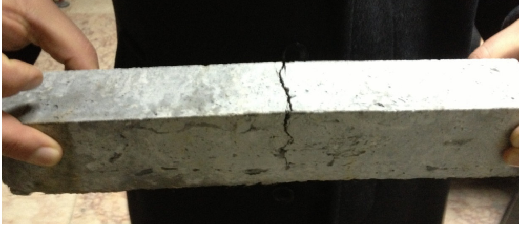
Şekil 4.10. Eğilme deneyi sonucu kırılan numune
