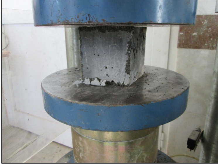
Şekil 3.6. Beton basınç dayanımı deneyi
