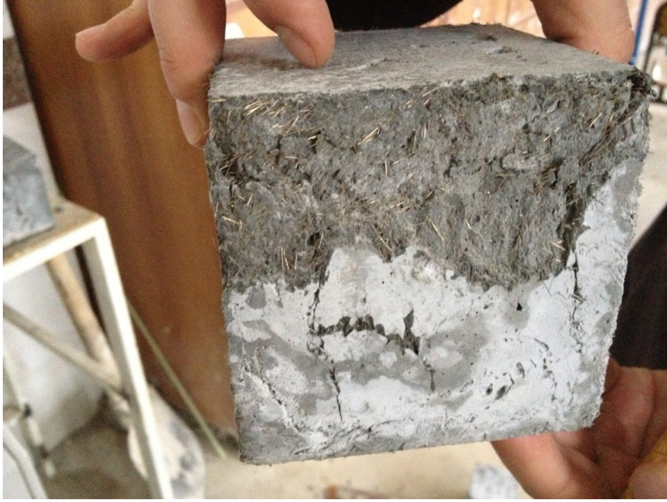
Şekil 4.2. Basınç deneyi sonucu kırılan numunenin yapısı
