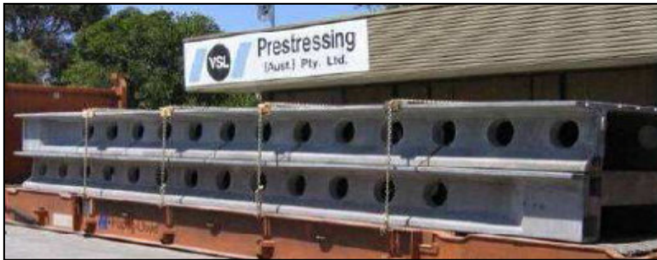
Şekil 2.13. Papatoetoe ve Penrose RPB kullanılarak yapılan üst geçit köprüsü kirişleri [40]
