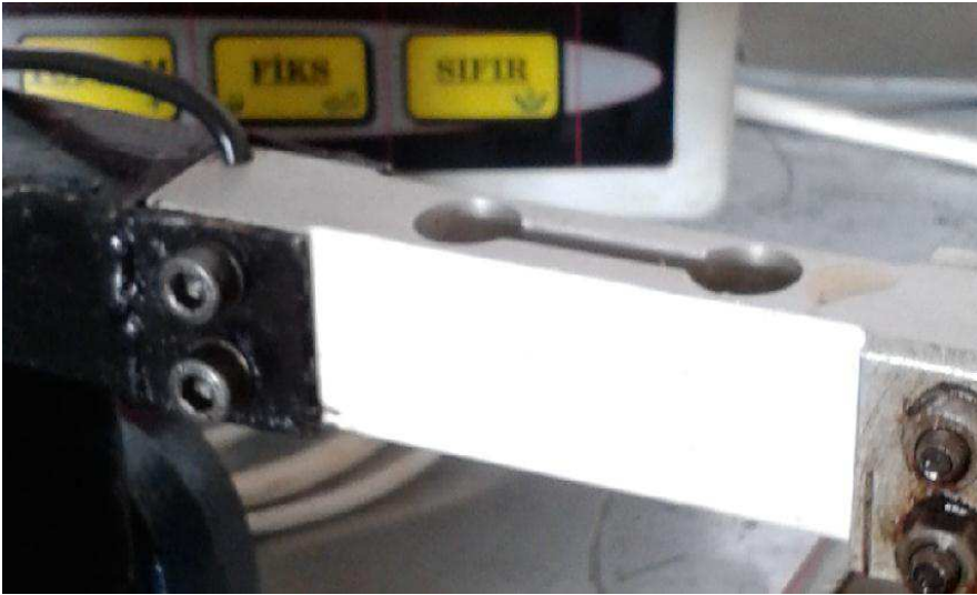
Şekil 5.6. Deney düzeneğine monte edilmiş haldeki yük hücresi
