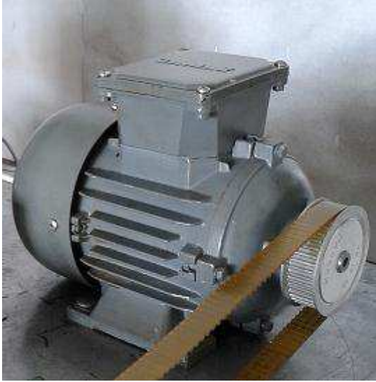
Şekil 5.7. Deney düzeneğine monte edilmiş haldeki alternatif akımla çalışan elektrik motoru
