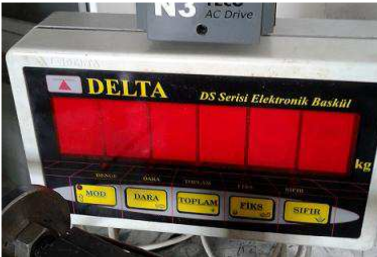
Şekil 5.8. Deney düzeneğine monte edilmiş haldeki elektronik baskül (gösterge)
