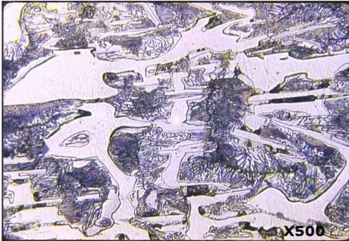
Şekil 1. 2. Tipik beyaz dökme demir yapısı [5]
