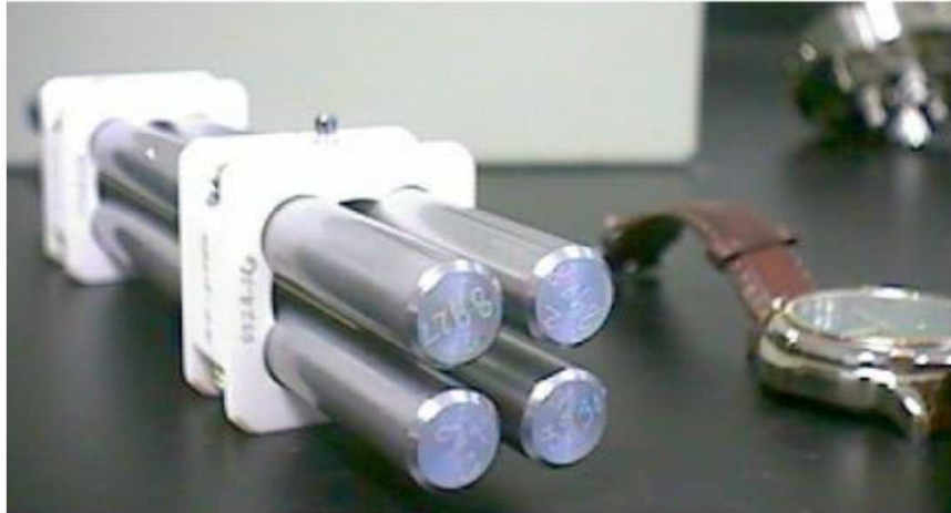
Şekil 2.6. Temizleme için MS spektrometresinden çıkan bir kuadrupol
