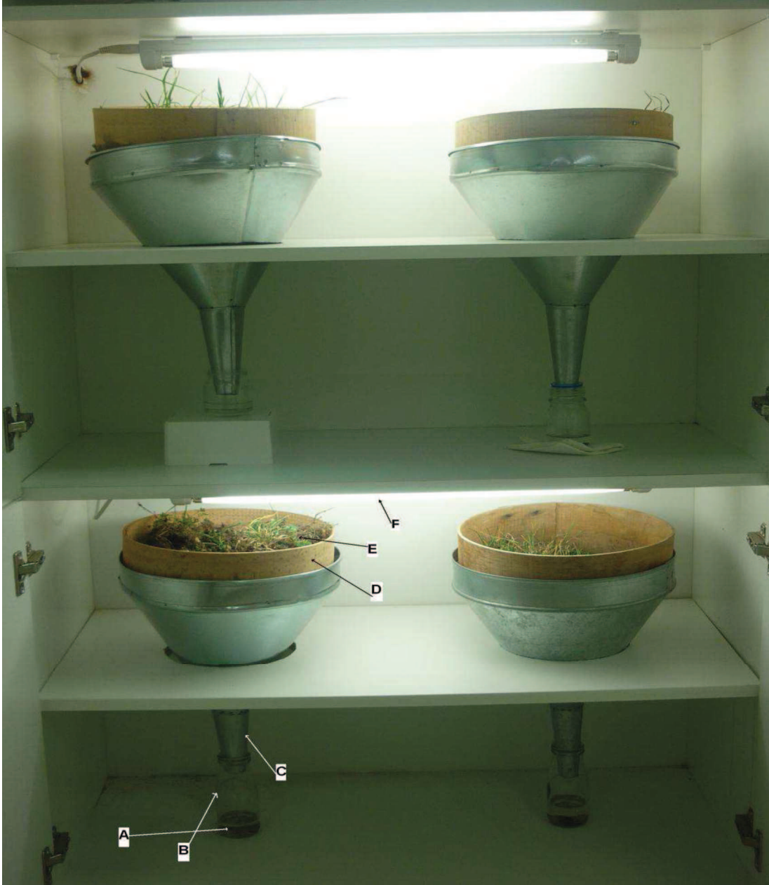
Şekil 2.4. Berlese hunisi: A-Toplama sıvısı (%70' lik alkol), B-Toplama şişesi, C-Huni, D-Elek E-Toprak, döküntü, F-Işık kaynağı
