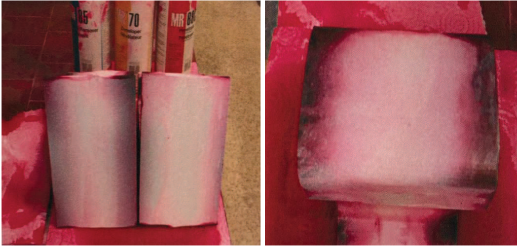
Şekil 7.1. Sıvı penetrasyon testi yapılan numune
