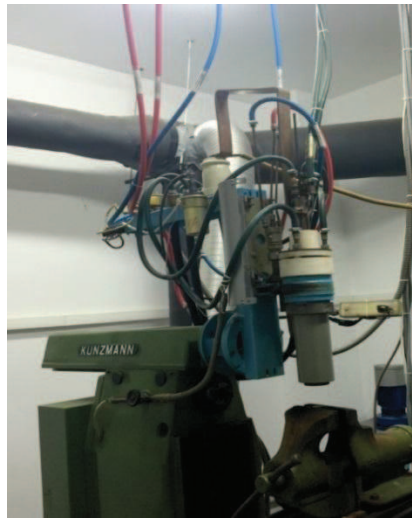
Şekil 6.1. Atım plazma uygulama sistemi (plazmatron)
