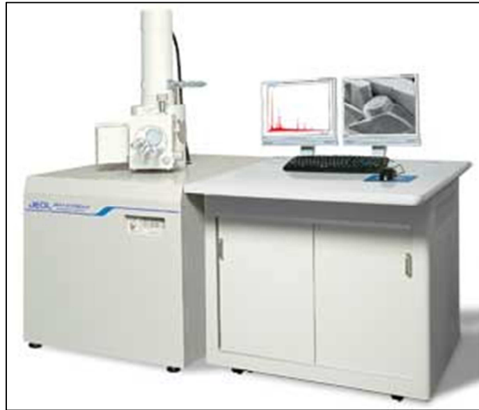
Şekil 4.7: Jeol JSM-6060 LV marka taramalı elektron mikroskobu.
