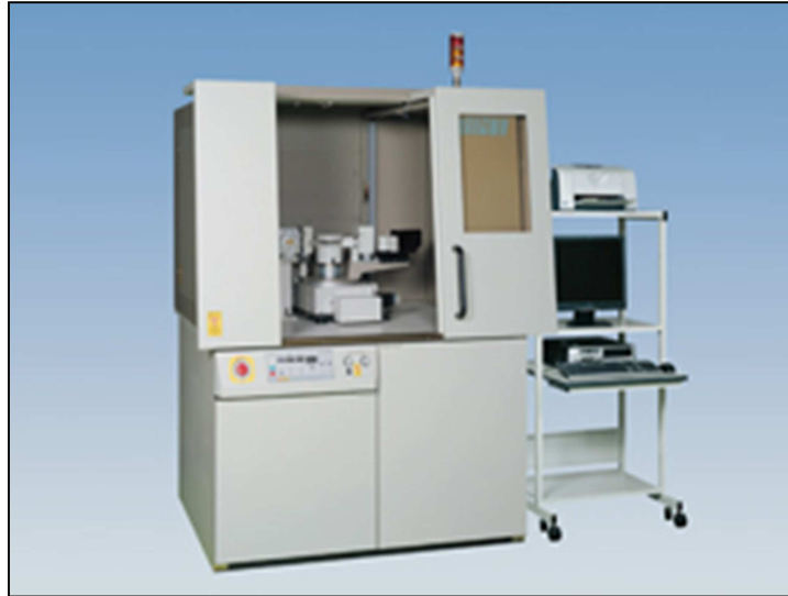
Şekil 4.6: Rigaku D/MAX 2000 marka X-ışınları difraktometresi.
