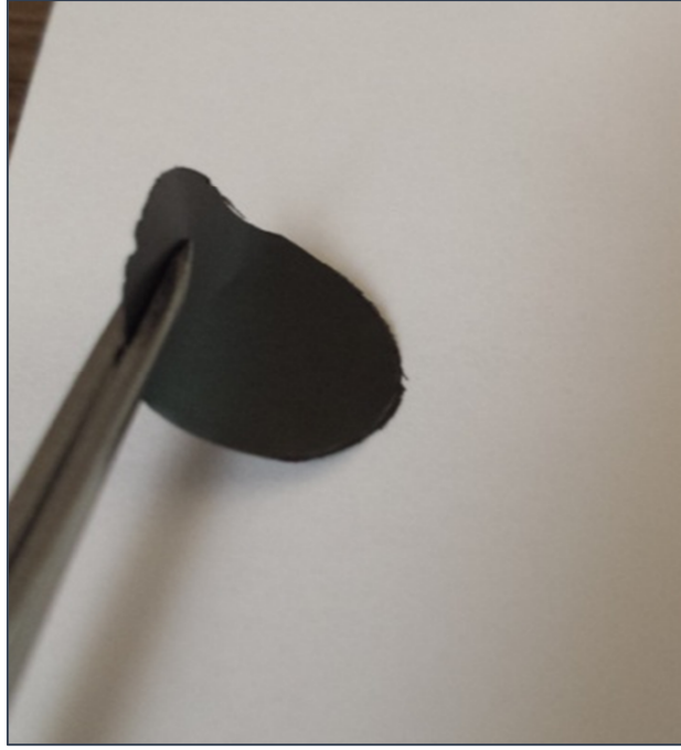
Şekil 4.5: \alpha -MnO 2 +GO serbest elektrot fotoğrafı.
