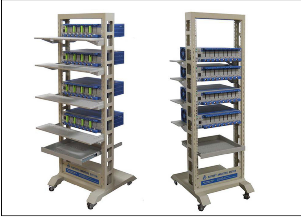
Şekil 4.10: Galvanostatik şarj/deşarj testleri için kullanılan MTI-BST8 elektrokimyasal analiz cihazı.
