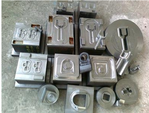
Şekil 1.17. Sıcak dövme hacim kalıpları
