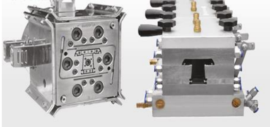
Şekil 1.9. Fışkırtma (ekstrüzyon) kalıpları
