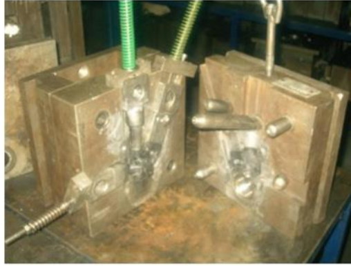
Şekil 1.16. Basınçlı döküm-hacim kalıpları
