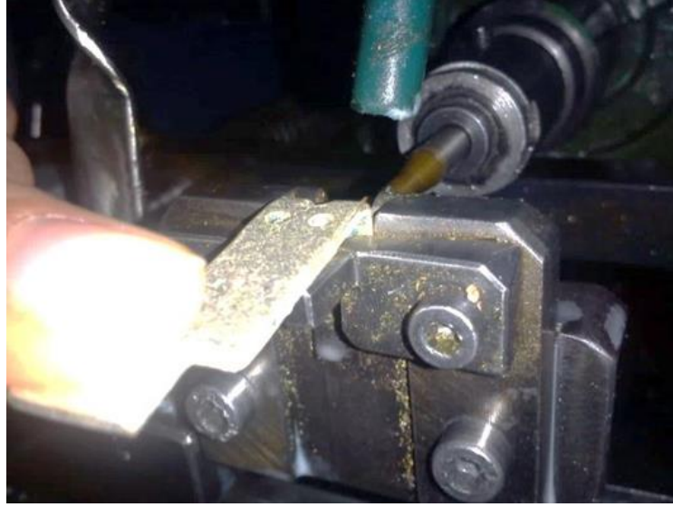
Şekil 4.14. Tolerans boşluğu ve zamanla oluşan deformasyon
