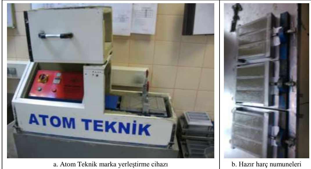
Şekil 5.5. Çimento harcınının yerleştirilmesi
