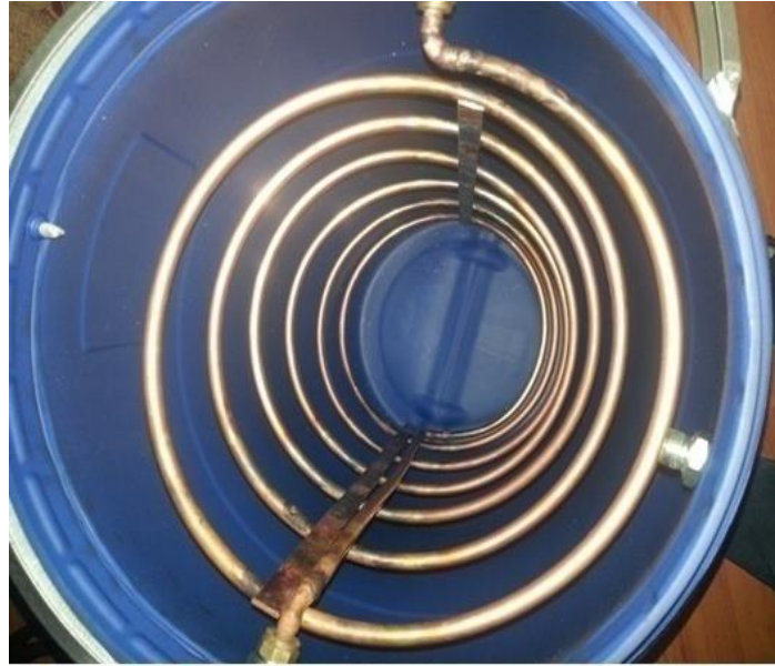
Şekil 5.5. Spiral borunun depoya sabitlenmiş hali
