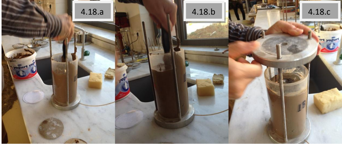
Şekil 4.18. Deney numunesinin hücreye yerleştirilmesi
