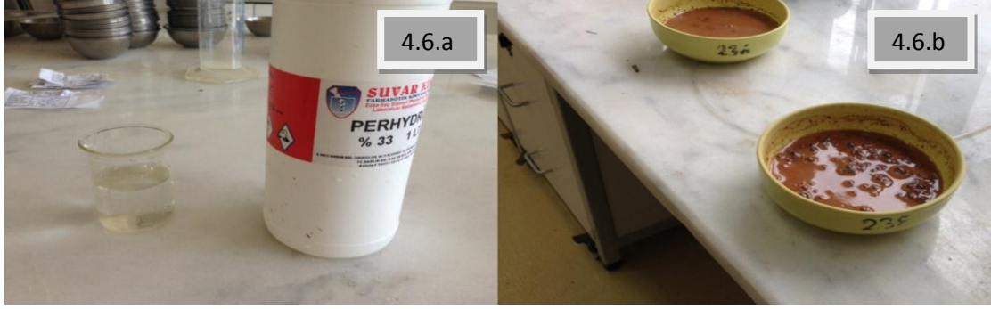
Şekil 4.6. 50 gr numunenin perhidrol ile yakılması
