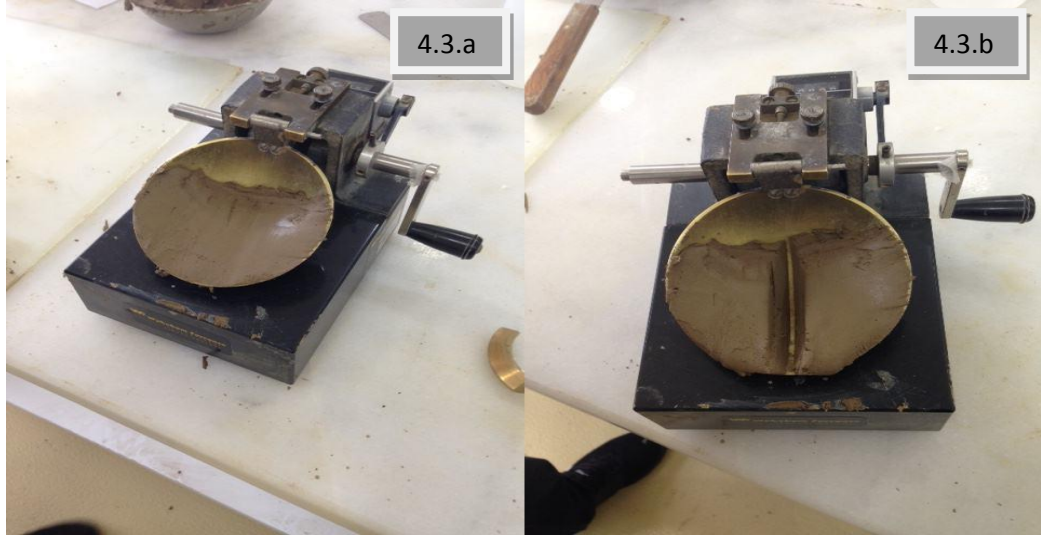
Şekil 4.3. Numunede oyuk açma bıçağıyla yarık açılması ve vuruşlar yapılması
