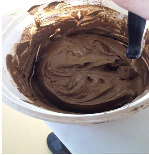
Şekil 4.17. Siltli kil deney numunesinin bulamaç haline getirilmesi
