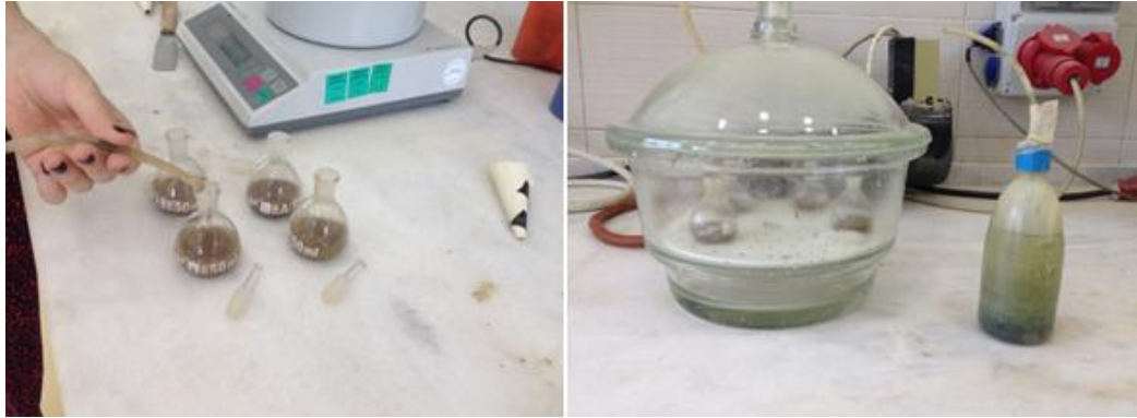
Şekil 4.12. Vakum ncesi numuneye su koyulması ve vakumlama ařaması
