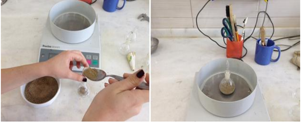
Şekil 4.11. Numunenin piknometreye koyulması ve tartılması
