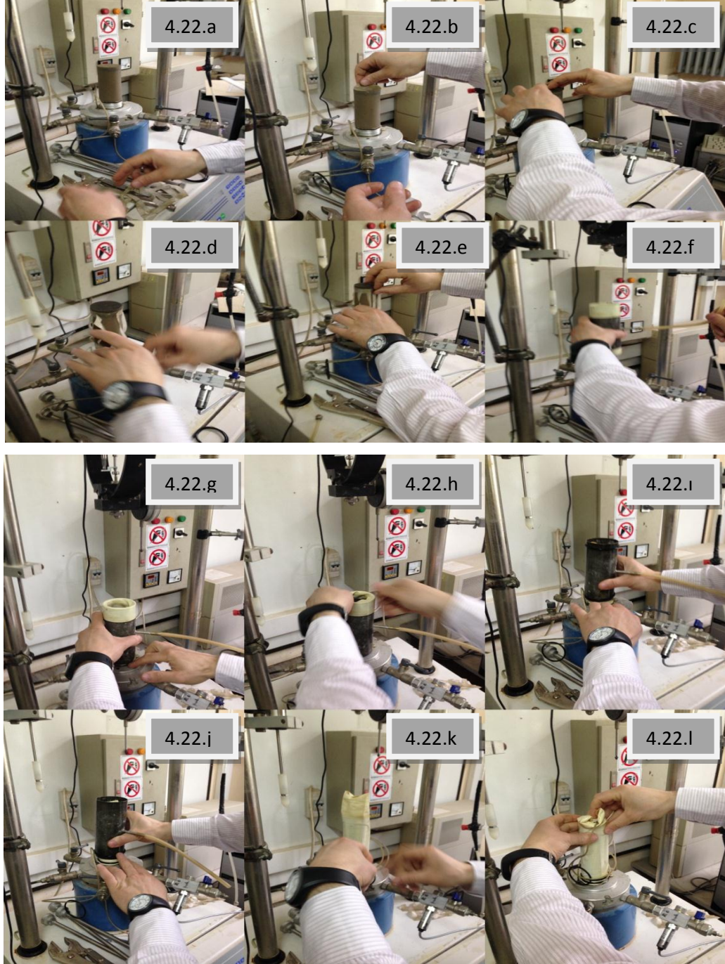
Şekil 4.22. Üç eksenli deney için numunenin hazırlanması işlemi
