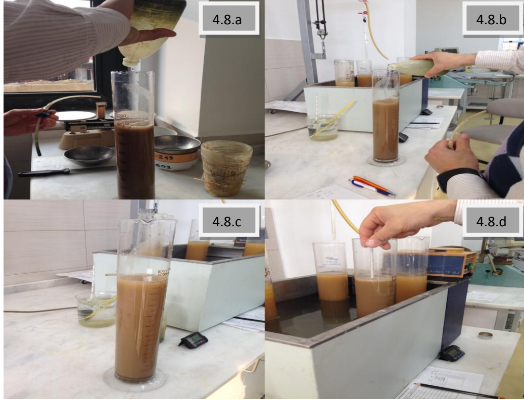
Şekil 4.8. Numunenin düzeneğe yerleştirilmesi ve hidrometre okumalarının alınması
