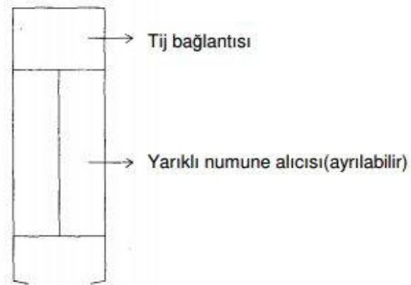
Şekil 2.11. SPT, örselenmiş numune alıcısı [43].
