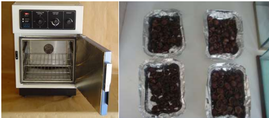
Şekil 4.8. Etüv fırını ve kurutma için hazırlanan numuneler
