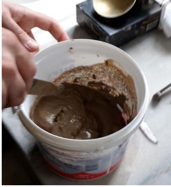
Şekil 4.3. Deney için bulamaç halinde hazırlanan deney numunesi
