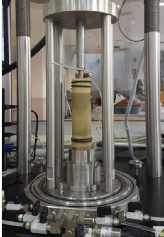
Şekil 4.7. GCTS deney cihazına yerleştirilmiş deney numunesi
