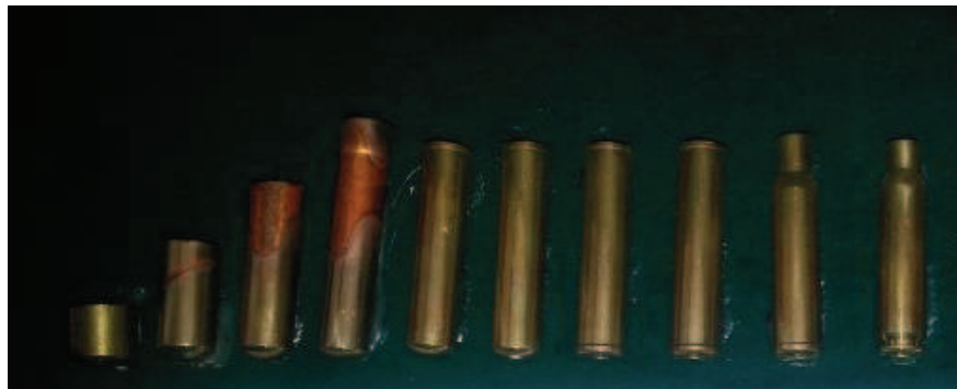
Şekil 2.13. 7,62x51 mm kovanın üretim aşamaları
