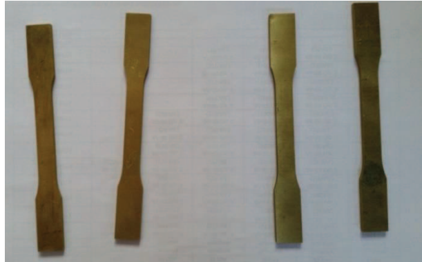
Şekil 3.4. Yüksük şeridinden hazırlanan pirinç çekme testi numuneleri
