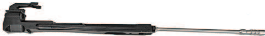
Şekil 2.10. Uzun kurslu bir tüfekte bütünleşik halde bulunan piston, piston mili ve mekanizma gövdesi [13]
