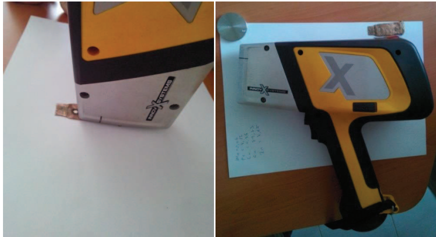
Şekil 3.6. 7,62x54R kovanının kaplama malzemesinin portatif XRF spektrometre ile analizi
