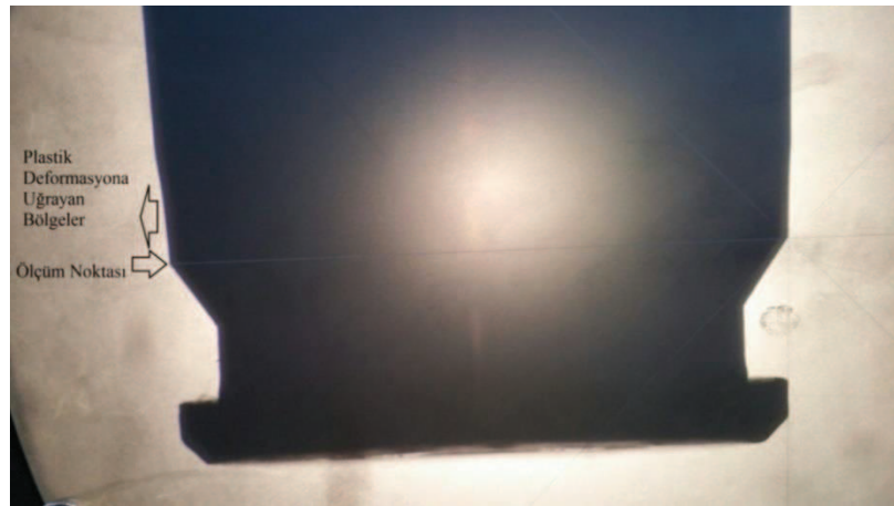
Şekil 4.17. 41,8 mm feyyür aralığına sahip tüfekle atılmış 7,62x51 mm pirinç kovanın profil projektör ölçme cihazındaki görünümü
