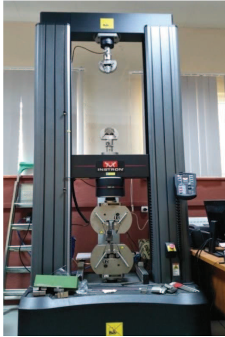
Şekil 3.3. Deneyin yapıldığı çekme testi cihazı
