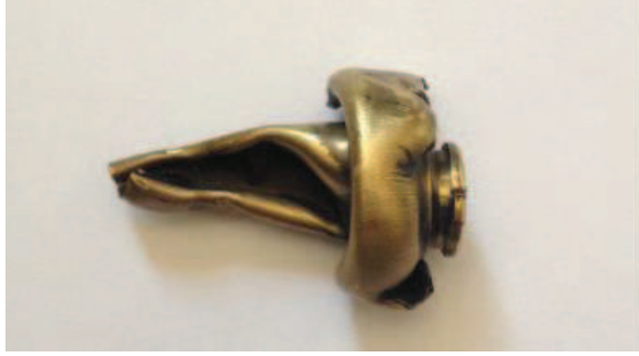
Şekil 2.4. Feyyür ölçüsü emniyetli değerde olmayan bir tüfekle yapılan atış sonucunda kovanın geldiği durum (kovanın şişen kısmı)
