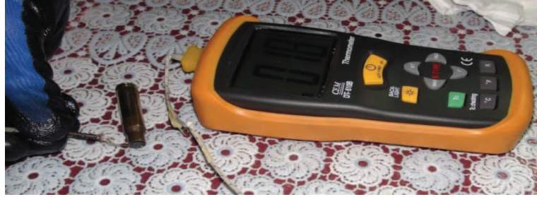
Şekil 3.7. Atış yapılmış bir kovanın sıcaklığının ölçülmesi
