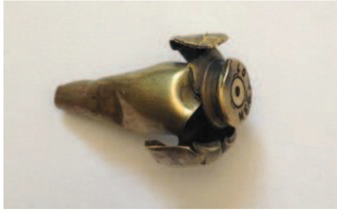
Şekil 2.5. Feyyür ölçüsü emniyetli değerde olmayan bir tüfekle yapılan atış sonucunda kovanın geldiği durum (kovanın yarılan kısmı)
