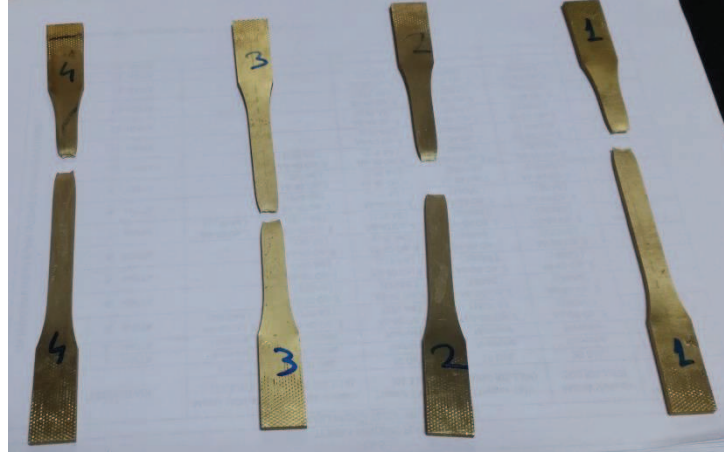
Şekil 3.5. Çekme testi sonrası pirinç numuneler
