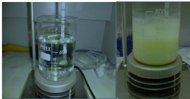
Şekil 2.4. Hidrotermal yöntemler ile HAP üretimi [19].
