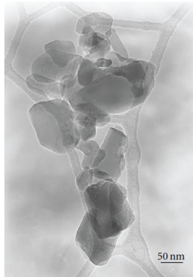
Şekil 2.2. Sentetik nano hidroksiapatitin morfolojisinin ve büyüklüğünün TEM görüntüsü [12].
