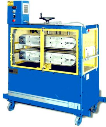
Şekil 5.13. PVC boru üretim hattındaki boru çekim makinesi [43]
