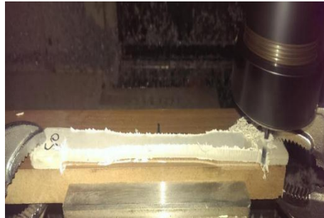
Şekil 6.11. CNC tezgahında çekme numunesi üretimi
