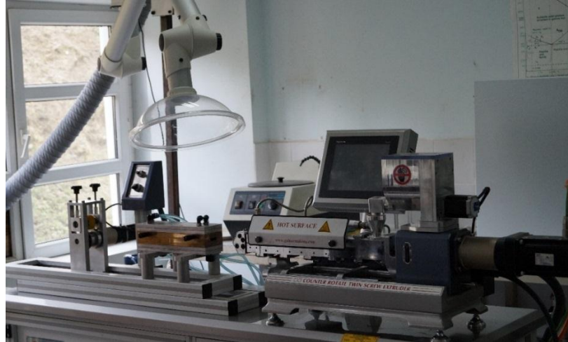
Şekil 6.6. Laboratuvar tipi çift vidalı ekstrüzyon cihazı
