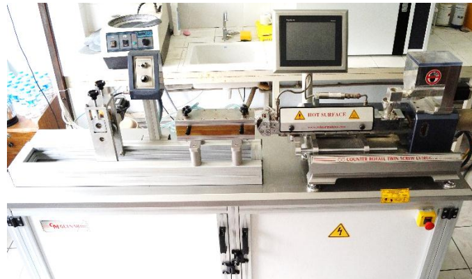
Şekil 5.6. Laboratuvar tipi çift vidalı ekstrüzyon cihazı
