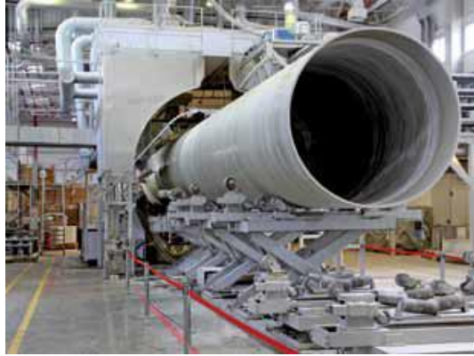
Şekil 4.2. CTP boru sürekli elyaf sarma metodu [29]
