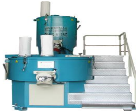
Şekil 5.4. PVC üretimi için kullanılan mikser sistemi [34]
