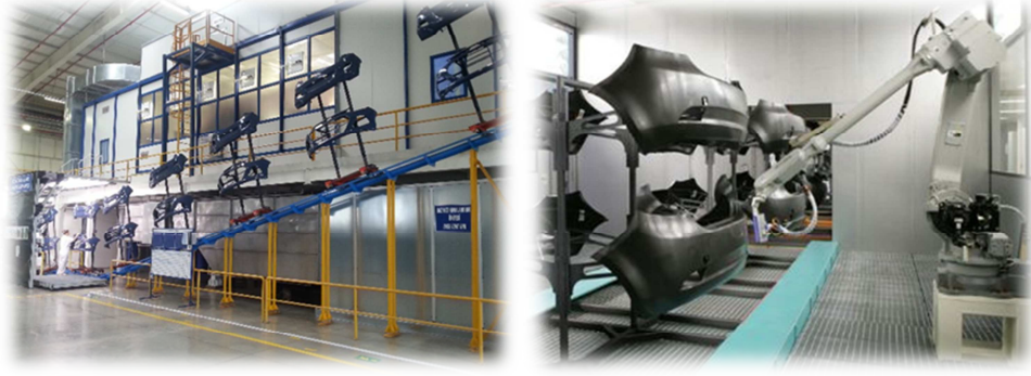
Şekil 1.6. Tampon boya hattı işlem görüntüleri
