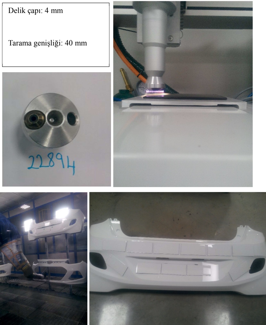
Şekil 3.27. Deneysel numunelerin hazırlanışı ve boyanması
