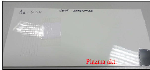
Şekil 3.36. Isı dayanımı testi sonrasında numune yüzey görüntüsü
