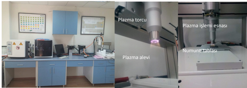
Şekil 2.1. Plazma yüzey aktivasyonu deneysel çalışmaları
