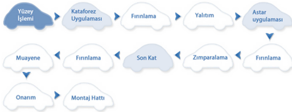
Şekil 1.4. Otomobil boya hattı işlem aşamaları [6]
