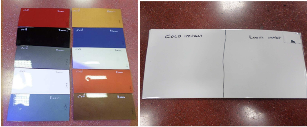
Şekil 3.29. a) Alev aktivasyonu sonrasında boyanmış b) Plazma aktivasyonu sonrasında boyanmış tampon numuneleri
