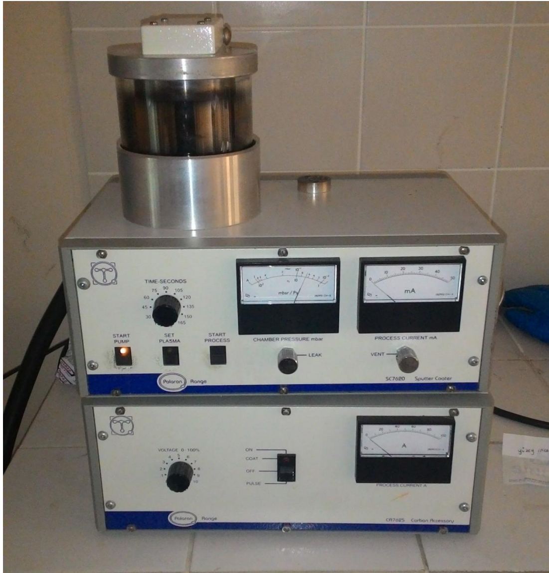
Şekil 2.5. Stub üzerindeki örnekleri altın tozu ile kaplama makinası
