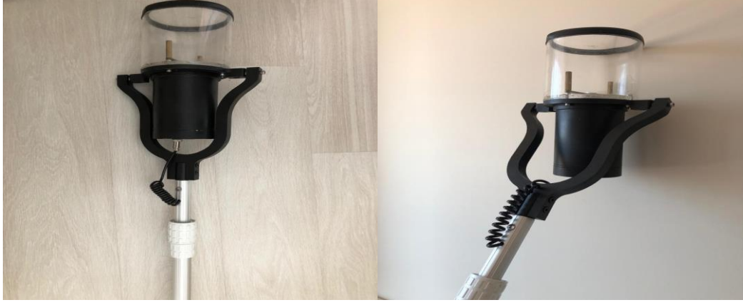
Şekil 4.7. Duman dedektörü test aparatının montajlanmış hali
