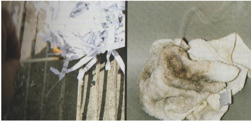
Şekil 2.3. Pilot ve otomatik tutuşmanın gösterimi [10]
