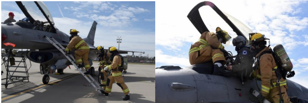
Şekil 6.3. Merdivenle muharip uçaktan pilot kurtarma uygulaması [50]
