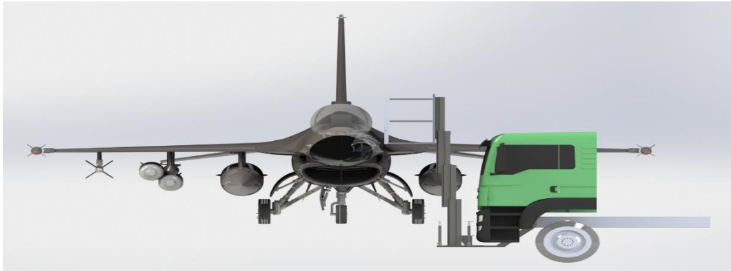
Şekil 6.6. Platformla muharip uçağa yanaşma modeli
