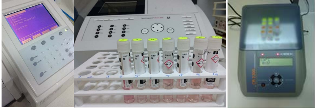
Şekil 3.7. Shimadzu UV- VIS spektrofotometre, Merck test kitleri ve Merck Pharo 300 spektrofotometre, Termoreaktör (WTW CR 4200 ve CR 2010-Germany)
