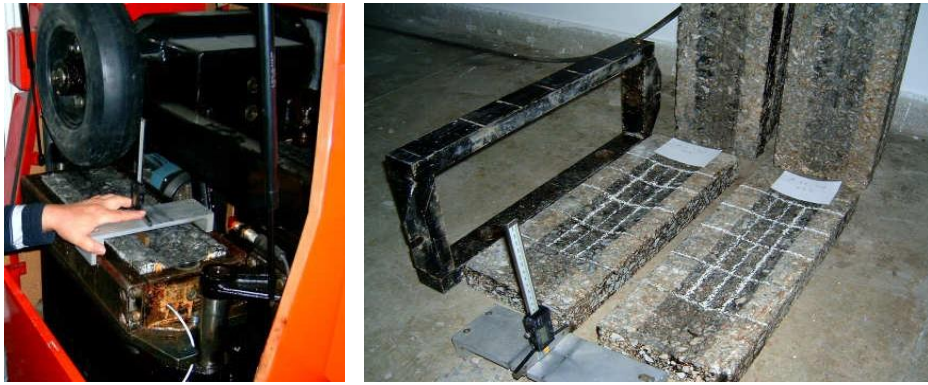
Şekil 3.11. Tekerlek izi ölçümü ve ölçüm alınan standart 15 nokta [24]
