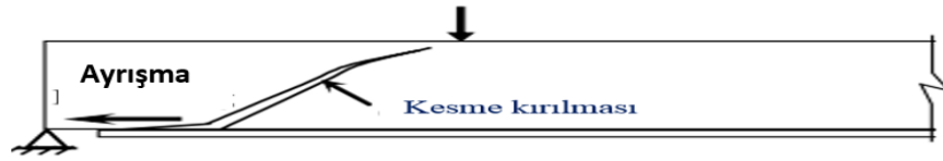
Şekil 2.7. Güçlendirilmiş kirişte kesme kırılması
