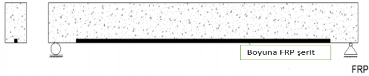
b). Betonarme kirişinin alt yüzeyinde FRP şeritle güçlendirilmesi
