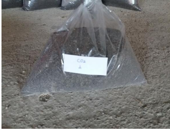
Şekil 3.4. %100 CO 2 Atık döküm kumu
