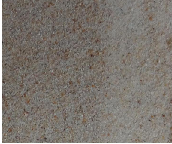
Şekil 3.1. Kullanılmamış döküm kumu
