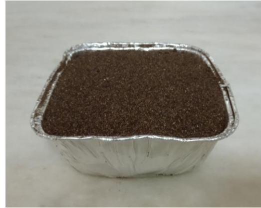
Şekil 3.3. Atık döküm kumu (Sertleştirici)
