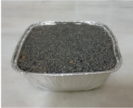
Şekil 3.2. Atık döküm kumu (CO 2 )
